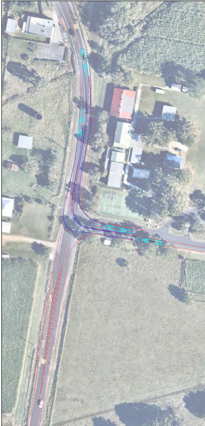
Figure 9.2: AV Swept Path Turns (West)
